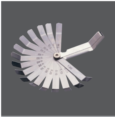
Szczelinomierze najczęściej wykorzystywane w trudno dostępnych miejscach.
